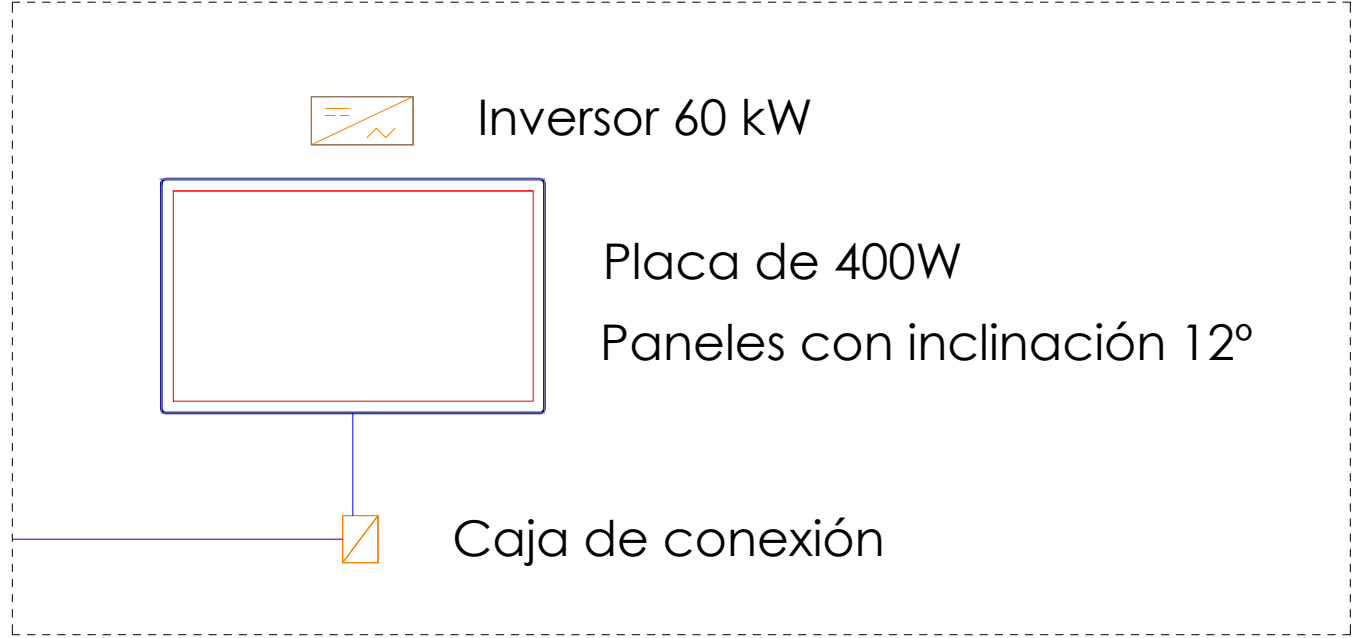
DETALLE MÓDULO FV
